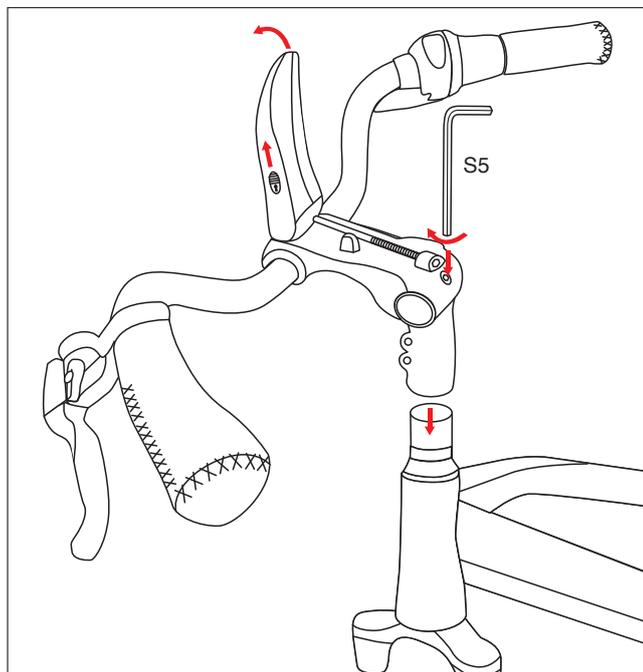
1. Abra la cubierta superior, alinee el vástago con el tubo principal y deslice sobre él. Apriete el tornillo en la parte superior de la tija.
