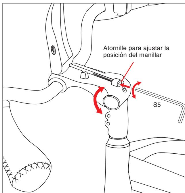
3. Mueva el manillar hacia arriba o abajo para ajustar el ángulo deseado y apriete el tornillo hacia atrás en la parte superior de la tija para bloquear el manillar en su lugar.
