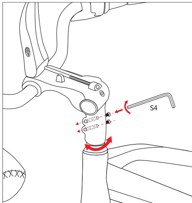
2. Alinee el manillar para que esté perpendicular a la rueda, luego inserte y apriete los dos tornillos que miran hacia los lados tal como se muestra a continuación.
