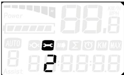
\* La pantalla no puede volver al estado normal hasta que el problema esté resuelto; los componentes eléctricos de la bicicleta eléctrica no funcionarán si hay un error en el sistema. Sin embargo, la bicicleta todavía se puede operar de forma convencional (sin asistencia de pedal).
