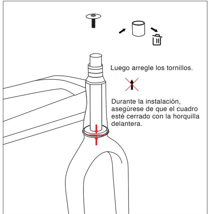
2. Coloque la arandela cónica, 2 arandelas gruesas y 1 arandela delgada en el extremo expuesto de la horquilla.
