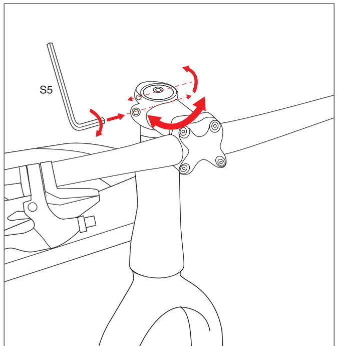
4. Alinee el manillar verticalmente con la rueda (es posible que deba aflojar el tornillo del paso 3 para hacer pequeños ajustes) y apriete los pernos en ambos lados del vástago.
