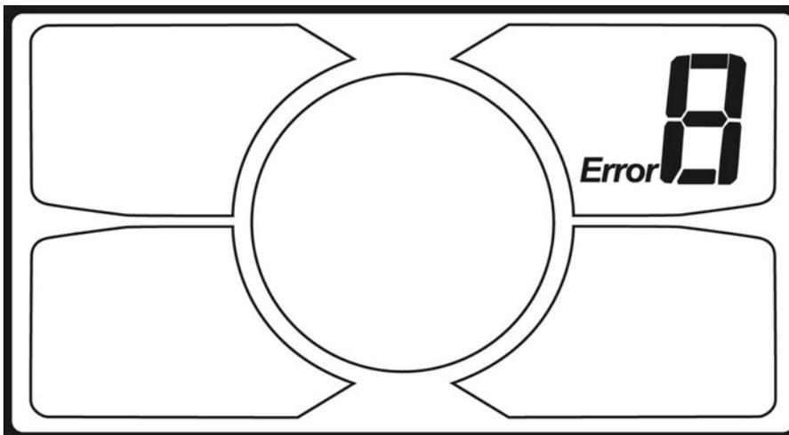
\* La pantalla no puede volver al estado normal hasta que el problema esté resuelto; los componentes eléctricos de la bicicleta eléctrica no funcionarán si hay un error en el sistema. Sin embargo, la bicicleta todavía se puede operar de forma convencional (sin asistencia eléctrica).
